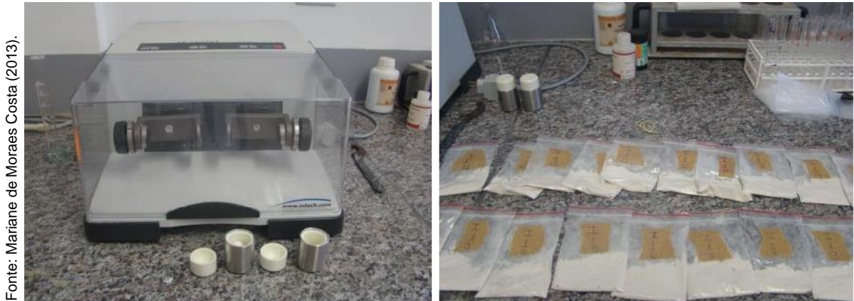
Figura 6 – Moinho de bolas de zircônio, à esquerda. Amostras moídas em moinho, à direita. Teresina, PI, 2012.
