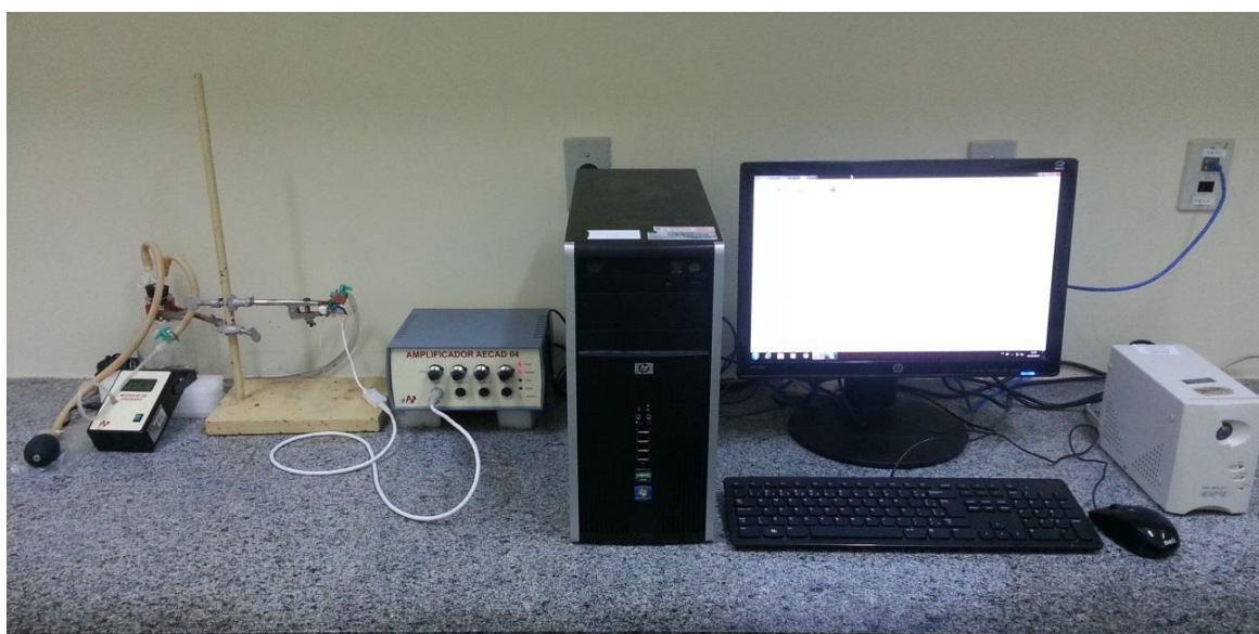
Figura 6: Sistema de aquisição de dados para registro da pressão arterial em ratas.
