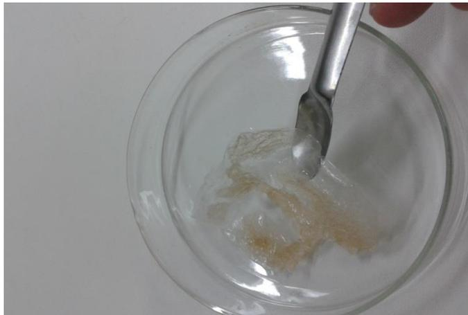
Figura 5: Pó obtido após o processo de secagem do produto obtido da reação do HPMC com ácido metafosfórico.
