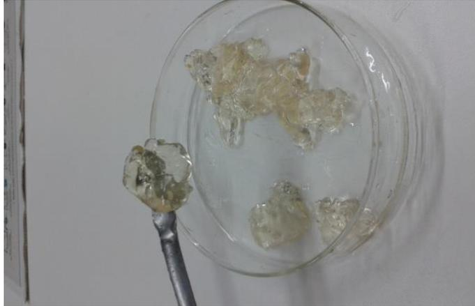
Figura 4: Filme polimérico obtido após o processo de secagem do produto obtido da reação do HPMC com o cloroetilfosfato.
