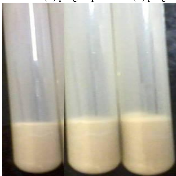
Figura III.3 – Formulações a base de paligorsquita centrifugadas após adequações: (A) paligorsquita natural (B) paligorsquita-BKC (C) paligorsquita-CTAC
