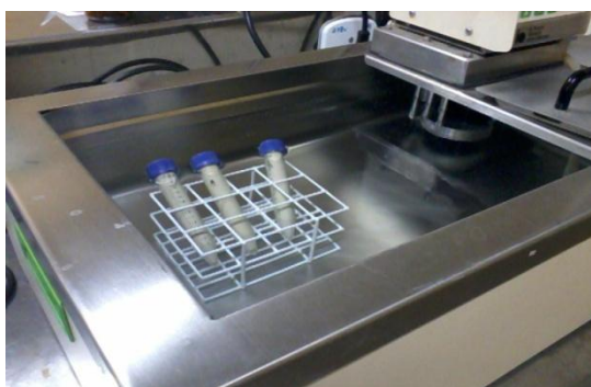
Figura III.4 – Teste do estresse térmico das formulações a base de paligorsquita: (A) início do teste (B1) antes do teste (B2) fim do teste
