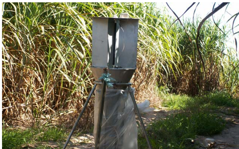
FIGURA 2. Armadilha luminosa modelo “Luiz de Queiroz” utilizada no estudo.
