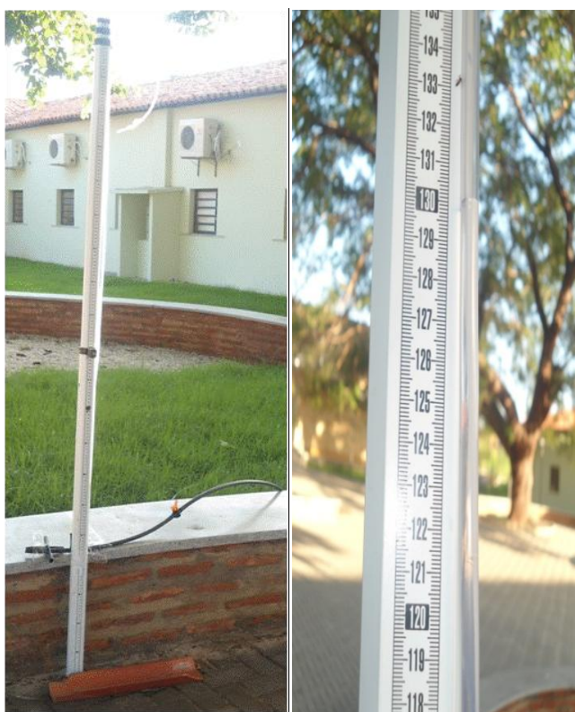
Figura1. Detalhe do microtubo e piezômetro marcando a pressão utilizada.
