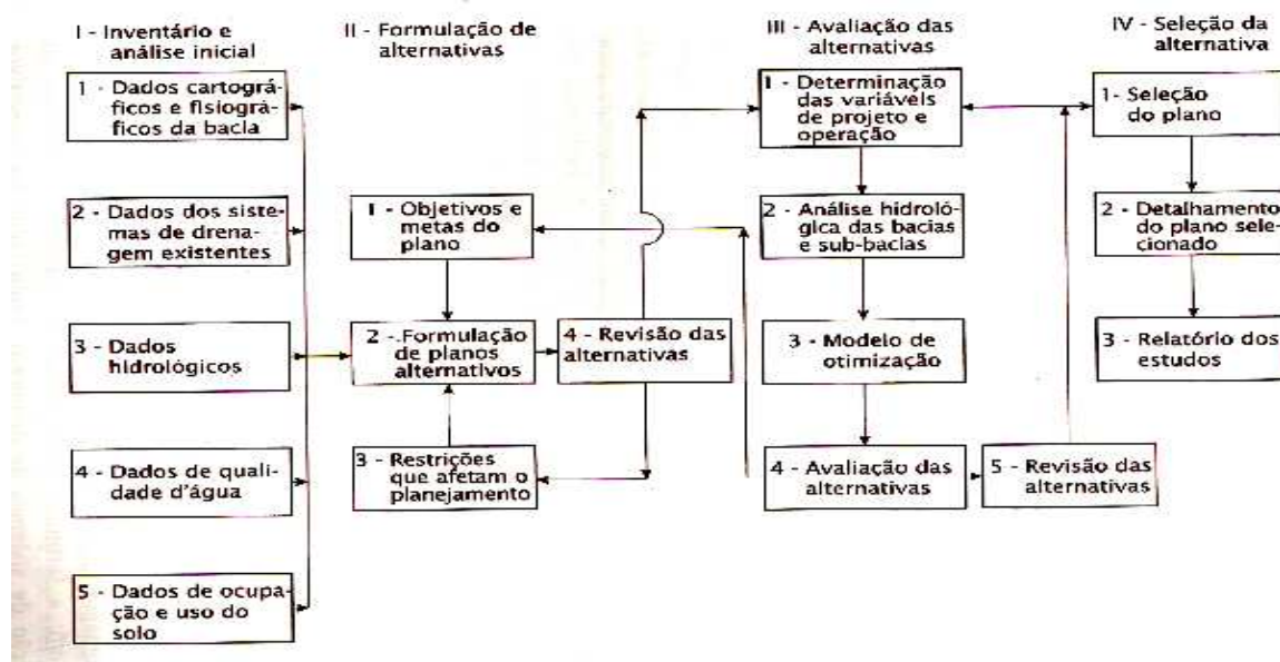
Figura 2.6: Planejamento de sistemas de drenagem urbana – Fluxograma das atividades principais Fonte: Canholi (2005, p. 28)
