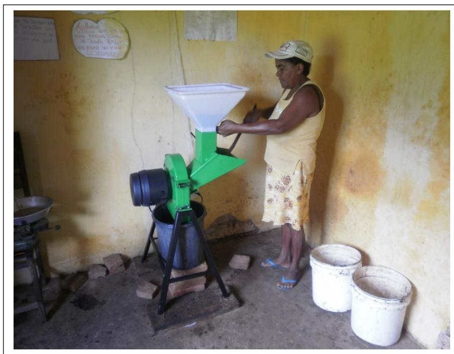
Fotografia 18: Máquina esmagadora da amêndoa do coco babaçu,
