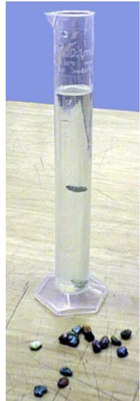
Figura 15: Aparato para a medida da viscosidade de líquidos.
