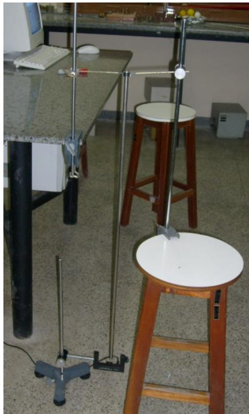
Figura 2: Aparato experimental para o pêndulo físico.
