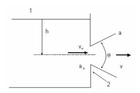
Se a entrada tem bordas agudas, há uma pequena contração do jato, que logo depois se expande, enchendo completamente o bocal que, na saída, funciona a plena seção.
