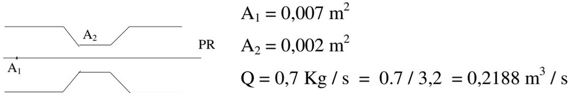
$$Q = AV \begin{cases} V_1 = 3,125 \text{ m / s} \\ V_2 = 10,9375 \text{ m / s} \end{cases}$$
