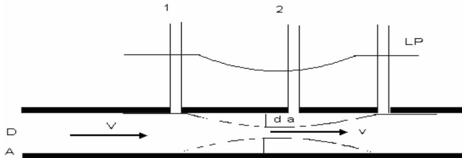
São dispositivos bastante usados, para medir as vazões em condutos sob pressão; o orifício da placa e o conduto devem ser concêntricos. A seção contraída se localiza a  $d/2$  depois do diafragma.
