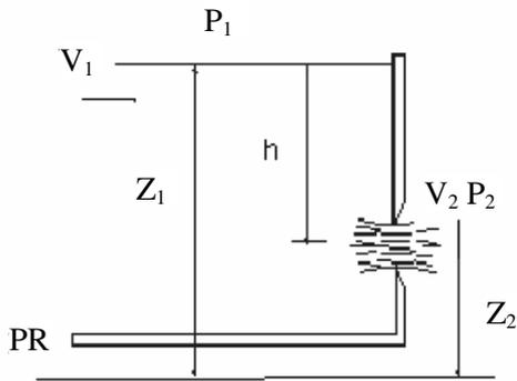
Devido a inércia das partículas, o jato que sai de um orifício sofre uma gradual contração, ficando a sua secção menor que a da abertura. A contração da veia diminui portanto a secção útil do escoamento.
