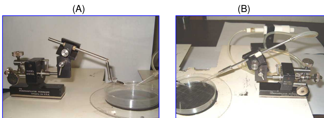
Figura 2. (A) Detalhe do braço do micromanipulador cuja extremidade é acoplada à lâmina para realizar o corte do embrião, (B) Detalhe do braço do micromanipulador cuja extremidade é acoplada à micropipeta de sucção.
