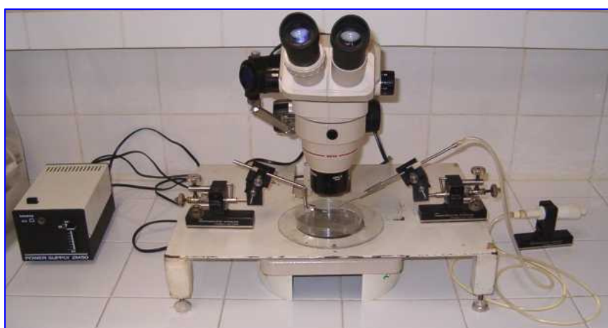
Figura 1 – Micromanipulador de embriões composto por dois braços apoiados sobre uma base adaptada a uma lupa estereomicroscópica.
