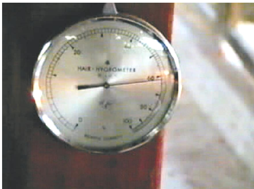
Figura 2 – Higrômetro usado na leitura da umidade no interior do galpão experimental
