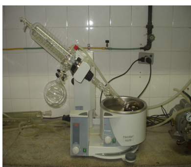
Figura 1: Obtenção do EE – rotavapor
