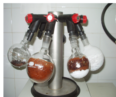
Figura 3: Secagem do EE no liofilizador
