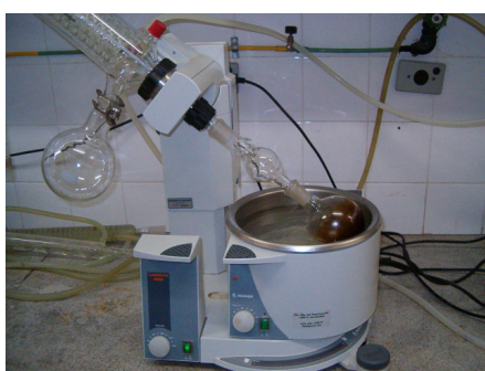
Figura 1: obtenção de EE – rotavapor Figura 2: secagem do material vegetal no liofilizador
