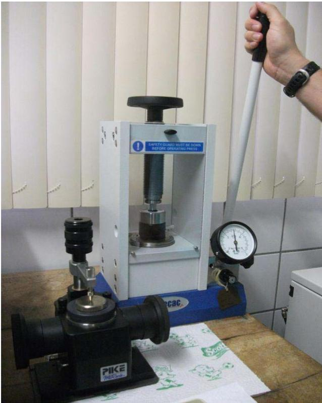
Pastilhador utilizado na preparação da amostra para análise no espectrômetro - Laboratório de Física – CCN
