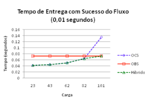
Figura 1b. Tempo de entrega com sucesso de um fluxo de 0.01 segundos com OCS, OBS e híbrido OCS/OBS
