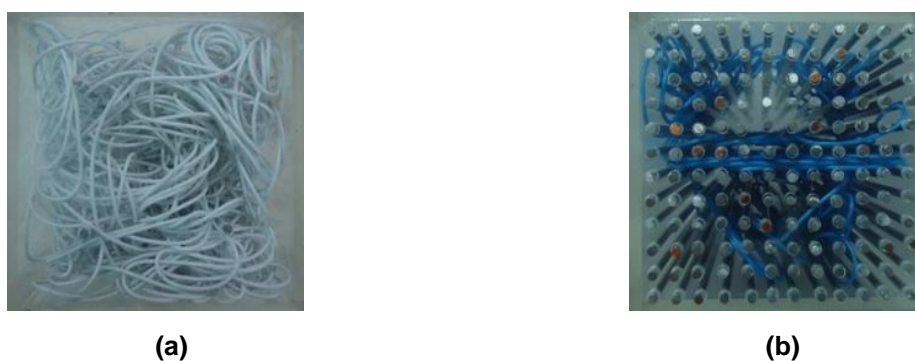
Figura 1: arranjo formado pelo empacotamento de fios flexíveis em cavidade cúbica com o numero de pilares n=4 , e taxa de empacotamento máximo p_{\text{máx}}=0,12\pm0,01 (a) e n=144 , taxa de empacotamento mínimo p_{\text{mín}}=0,05\pm0,006 (b) .
